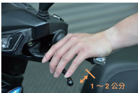
圖 2-1 煞車拉桿放鬆時
