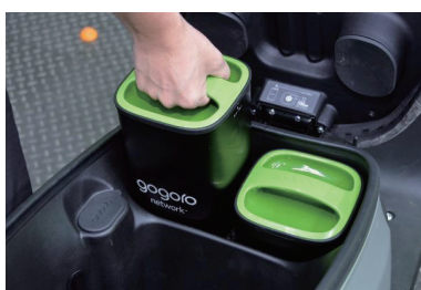
圖 1-4 電動機車使用換電方式
