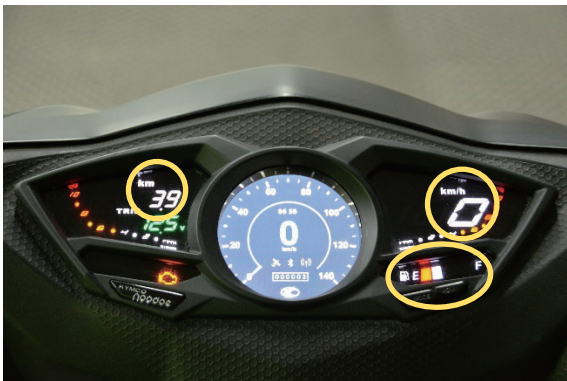
圖 2-5 顯示汽油量、里程及時速
