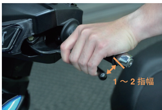
圖 2-2 煞車拉桿拉緊時
