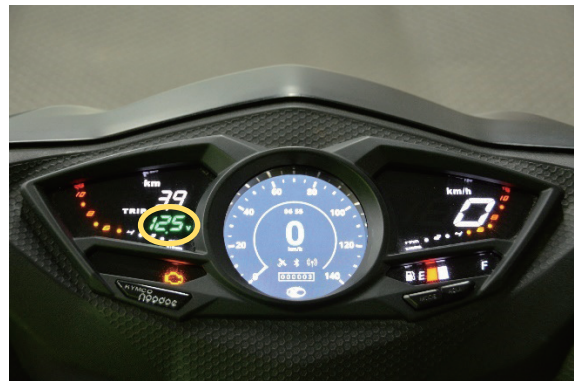
圖 2-6 顯示電瓶電壓值
