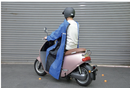
雨衣反穿穿著示例 (易造成雨衣勾到其他車輛或捲入車輪造成事故發生)
