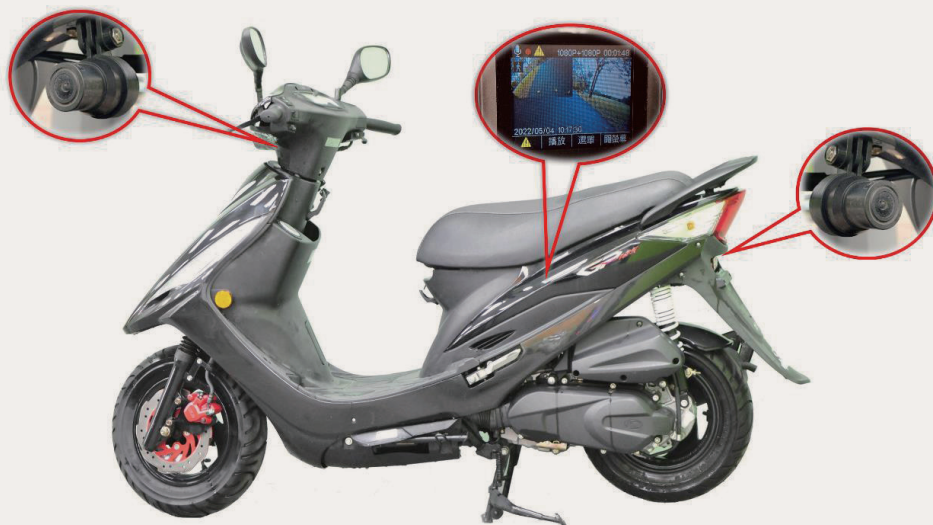
圖 3-16 常見機車行車影像記錄器主要組件裝置位置
