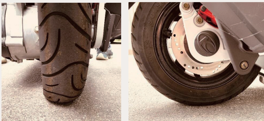
圖 3-17 胎壓正常時，機車荷重後輪胎外形仍接近正圓形
