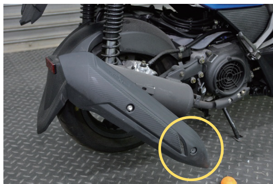
圖 2-23 機車防燙蓋掉落
