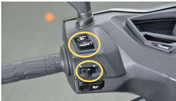
圖 2-11 遠近燈及方向燈切換開關
