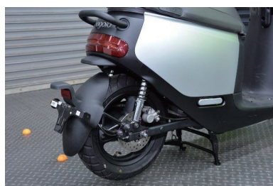
圖 1-3 電動機車無排氣管
