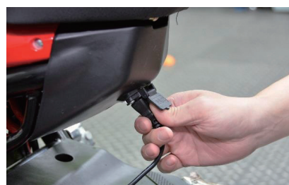
圖 1-5 電動機車使用充電方式
